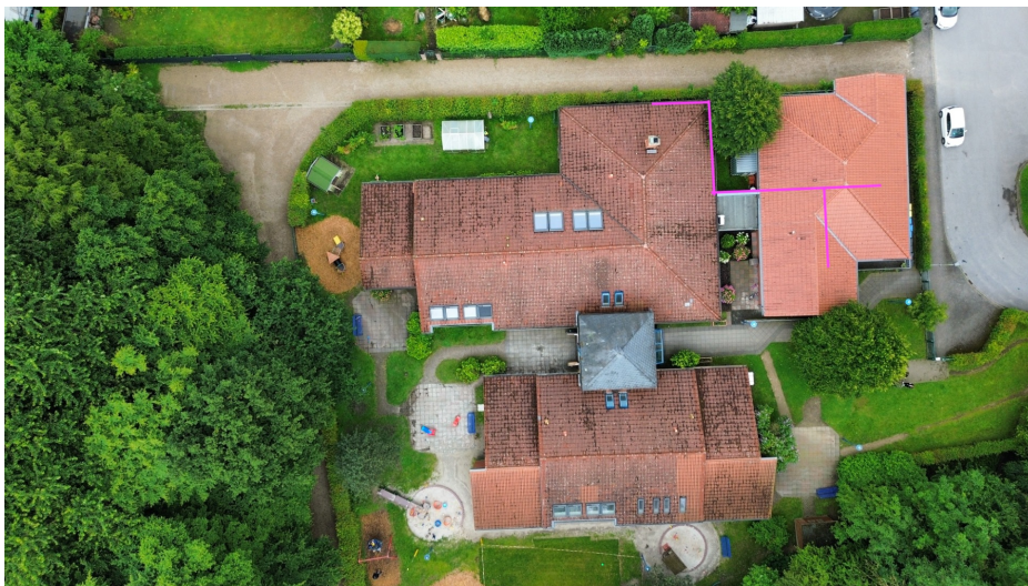
Abbildung 9: Kabelführung DC außen
