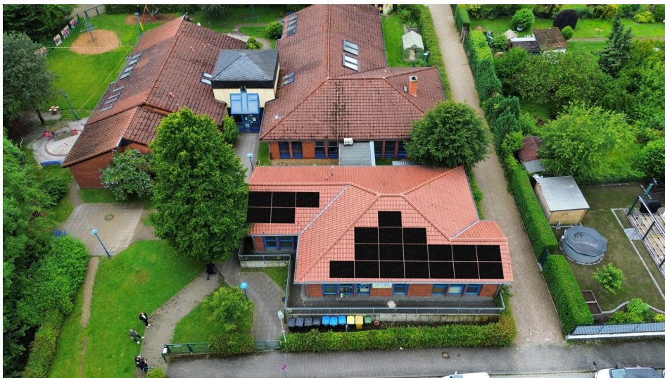
Abbildung 6: Mögliche Modulbelegung
